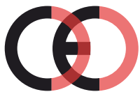
Virheellinen CE-merkki (liian lähellä)
